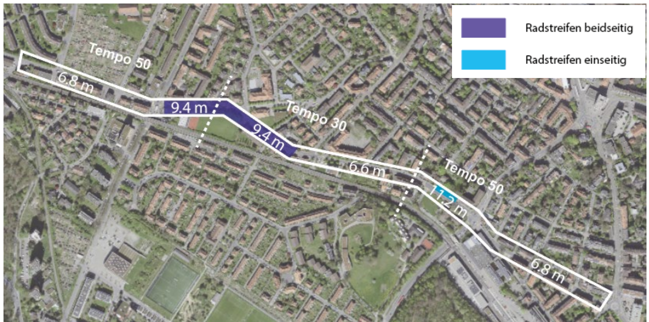
Abbildung 10 Strecke Weissensteinstrasse mit vorhandener Radinfrastruktur, Temporegime und vorhandenen Fahrbahnbreiten.
