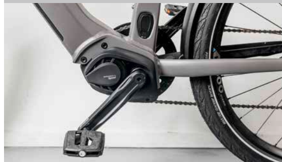
Zentraler Schwerpunkt dank Mittelmotor
