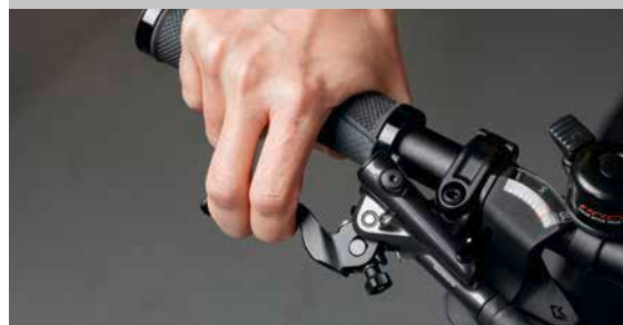
Richtig bremsen bei Scheibenbremsen: mit zwei Fingern, optimal nur mit einem
