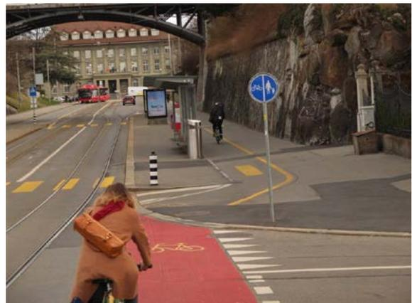
Wegen Sturzgefahr (knappe Abstände zwischen Geleisen und Tramhaltestelle) wurde das Trottoir in Aufstiegsrichtung für den Veloverkehr freigegeben. Trennung mittels ununterbrochener Linie.
